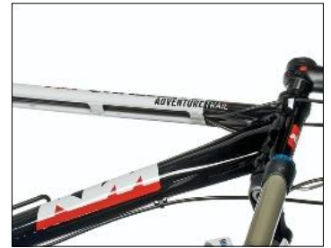
Aufgeräumt: Alle Züge und Leitungen verlegt KTM in eine Sicke unterhalb des Oberrohrs und nennt dies zurecht „Clean Shape“.
