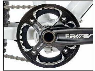
Auch für Stock und Stein: 33 Zähne am Kettenblatt lassen verschwenderisch viel Bodenfreiheit unter dem hoch positionierten Tretlager.
